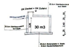
SCHNITT B-B (SENKGRUBE)
