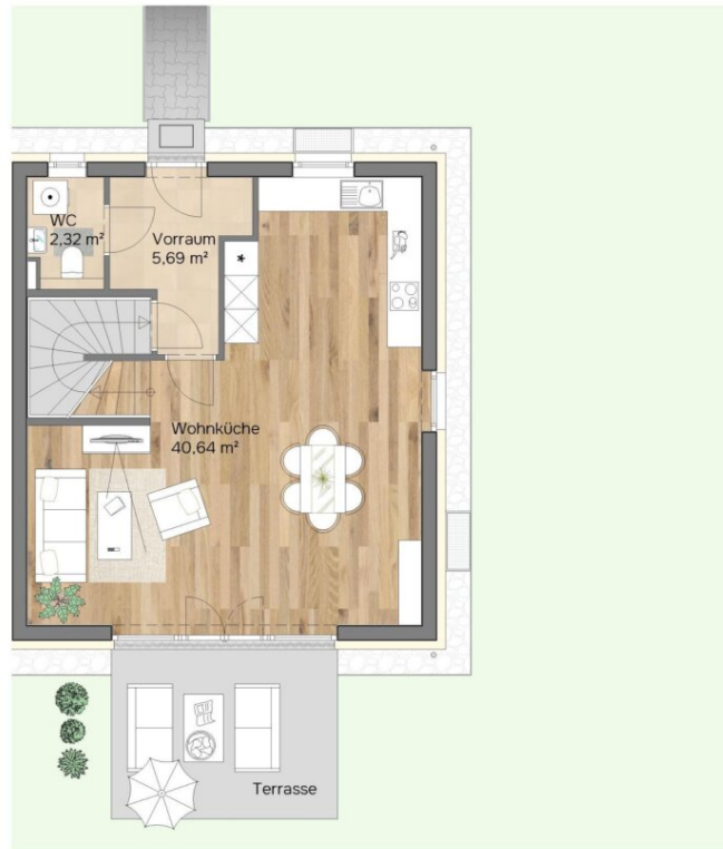
Erdgeschoss Raumhöhe 2,50 m
