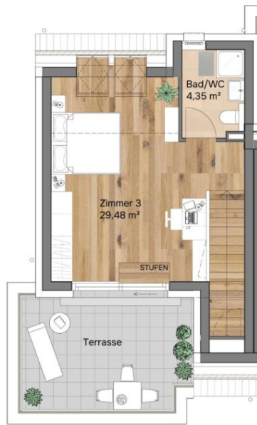
Dachgeschoss Raumhöhe 0,20m - 2,53 m
