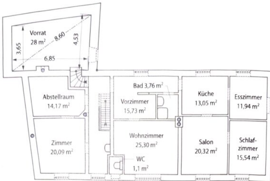
Obergeschoss: Dicke der Außenwände 50 cm
