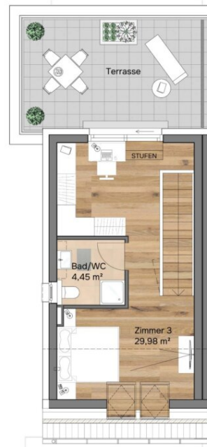
Dachgeschoss Raumhöhe 0,20m - 2,54 m
