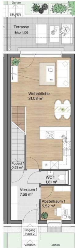
Erdgeschoss Raumhöhe 2,64 m
