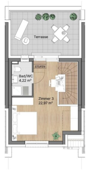
Dachgeschoss Raumhöhe 0,20m - 2,54 m
