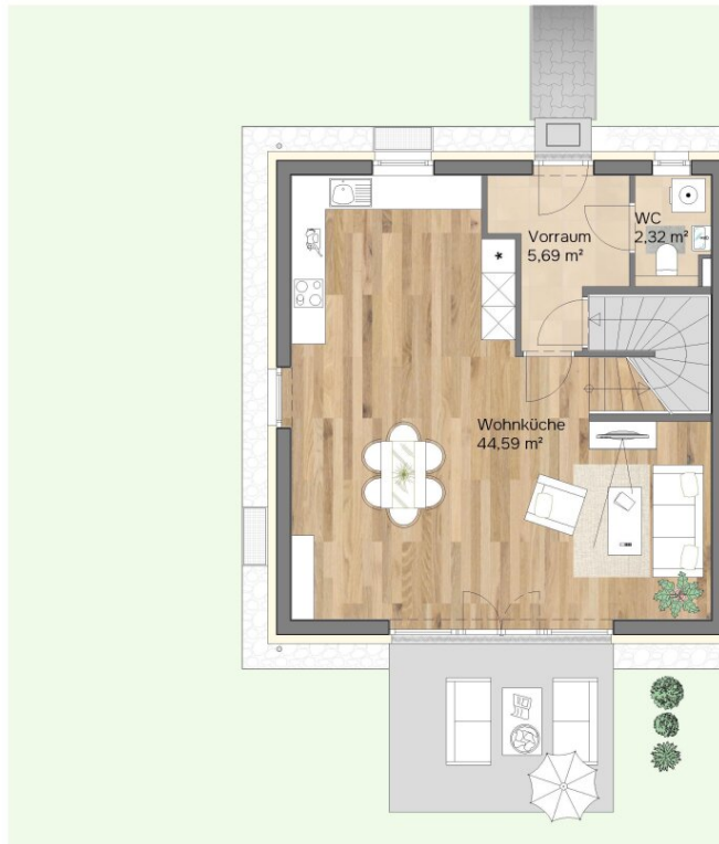
Erdgeschoss Raumhöhe 2.50 m
