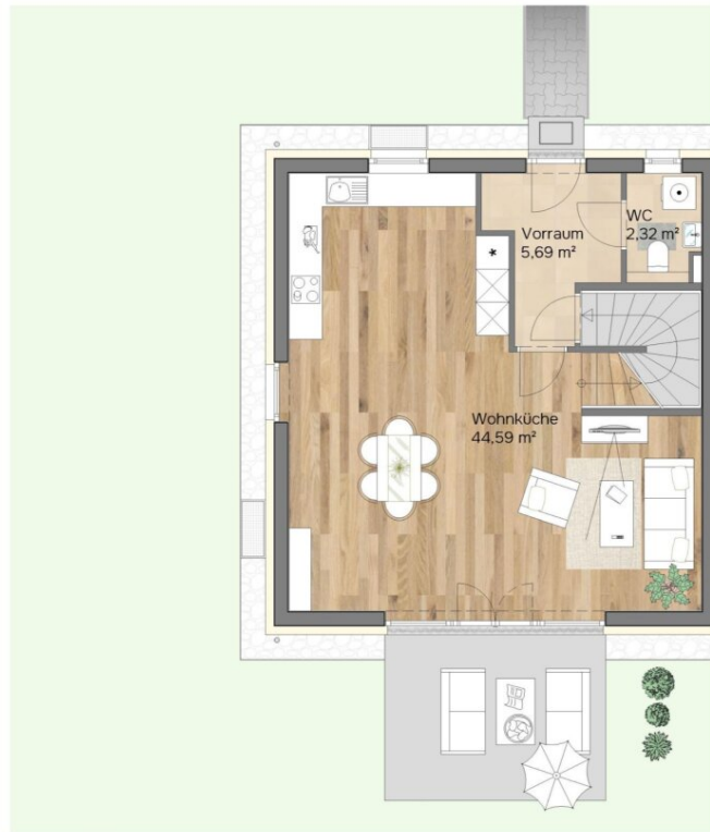
Erdgeschoss Raumhöhe 2,50 m
