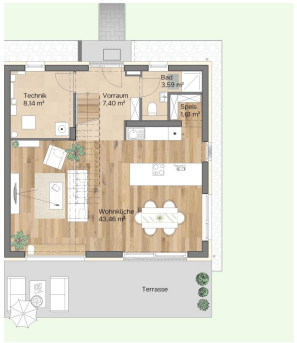
Erdgeschoss Raumhöhe 2,05 m
