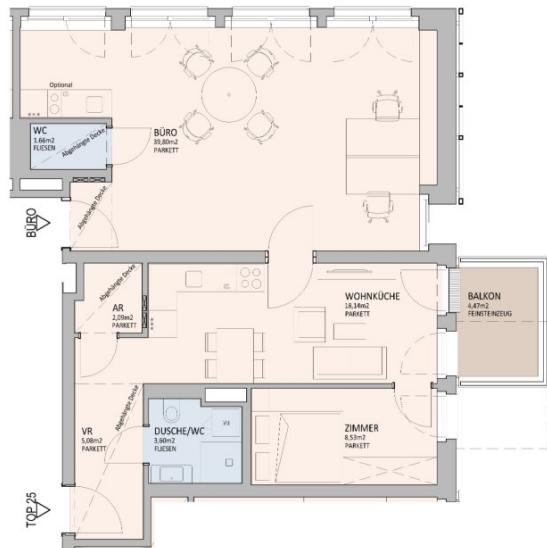
DIESER PLAN IST ZUM ANFERTIGEN VON EINBAUMÖBELN NICHT GEEIGNET, DIE DARSTELLUNG IST LEDIGLICH ALS FURNITURVORSCHLAG ZU VERSTEHEN. FÜR DIE ANFERTIGUNG VON EINBAUMÖBELN SIND NATURMASSE ZU NEHMEN UND BAUWERKE NICHT AN AUSSENWÄNDEN STELLEN, DA DIE GEFAHR VON SCHIMMELBILDUNG BESTEHT.
