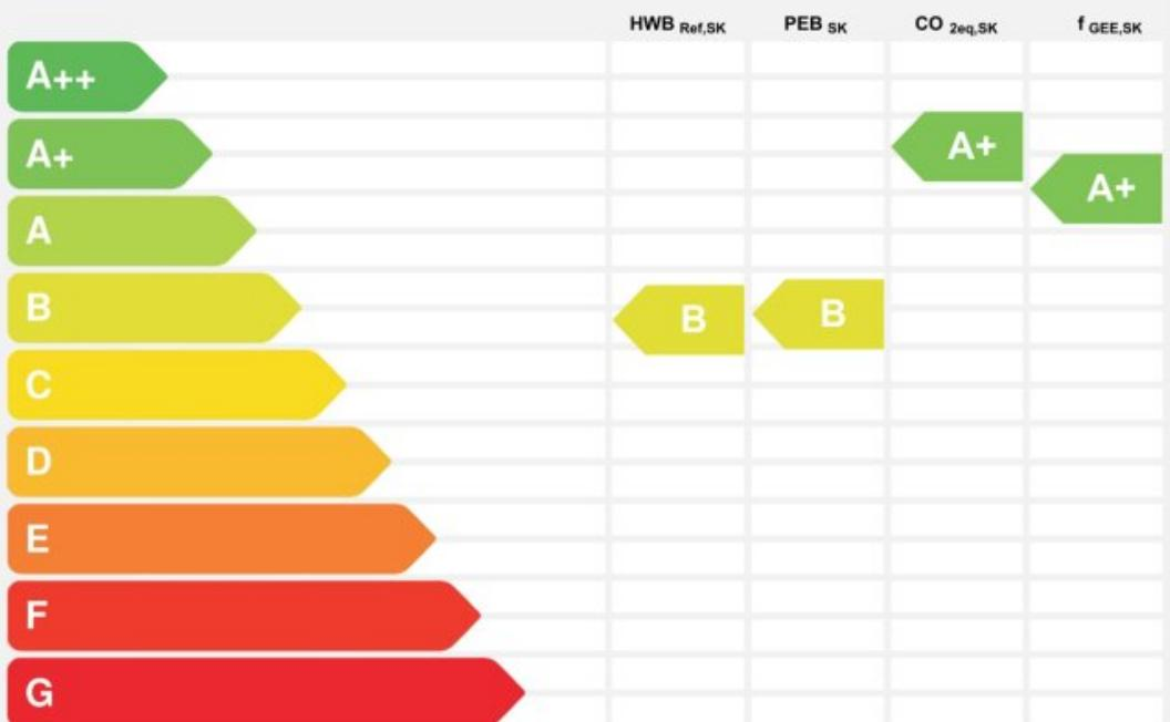
**HWB<sub>Ref</sub>**: Der **Referenz-Heizwärmebedarf** ist jene Wärmemenge, die in den Räumen bereitgestellt werden muss, um diese auf einer normativ geforderten Raumtemperatur, dazu Berücksichtigung allfälliger Erträge aus Wärmerückgewinnung, zu halten.
