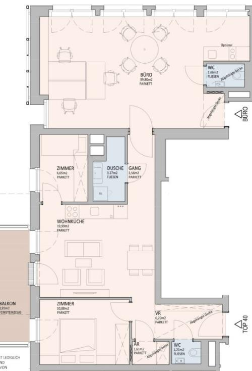
DIESER PLAN IST ZUR ANFERTIGUNG VON EINBAUMÖBELN NICHT GEDRUCKT, DIE DARSTELLUNG IST LEDIGLICH ALS DURCHFLÜTUNGSZURICHTUNG ZU VERSTEHEN. FÜR DIE ANFERTIGUNG VON EINBAUMÖBELN SIND NATURMASSSE ZU NEHMEN! EINBAUMÖBEL NICHT AN AUSENWÄNDE STELLEN, DA DIE GEFAHR VON SCHIMMELBILDUNG BESTEHT.
