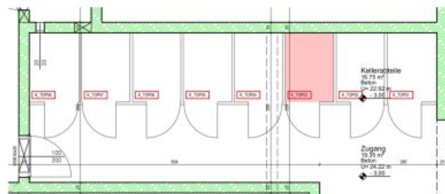
Planausschnitt KELLERGESCHOSS - Abteil TOP 03 - WEST Planstand = Ausführungsplan M: 1:100
