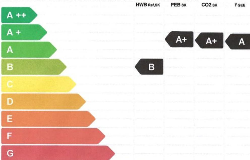
**HWB:** Der Referenz-Heizwärmebedarf ist jene Wärmemenge, die in den Räumen bereitgestellt werden muss, um diese auf einer normativ geforderten Raumtemperatur, ohne Berücksichtigung allfälliger Erträge aus Wärmerückgewinnung, zu halten.
