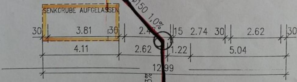
EINMÜNDUNG IN DEN STRASSENKANAL
