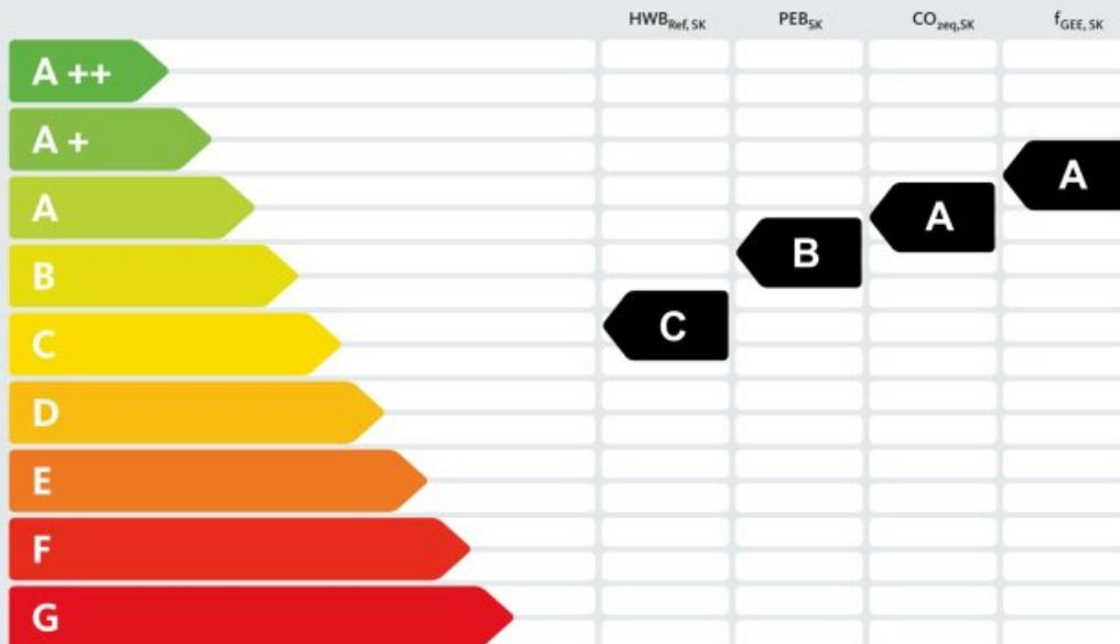
**HWB<sub>Ref</sub>:** Der **Referenz-Heizwärmebedarf** ist jene Wärmemenge, die in den Räumen bereitgestellt werden muss, um diese auf einer normativ geforderten Raumtemperatur, berücksichtigung allfälliger Erträge aus Wärmerückgewinnung, zu halten.
